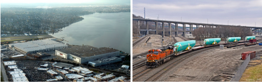
Boeing 737'nin üretildiği Renton fabrikası(solda) ve 737 gövdelerini taşıyan tren(sağda)
