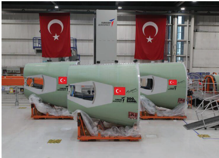
TUSAŞ tarafından üretilen A320 gövde parçası.
