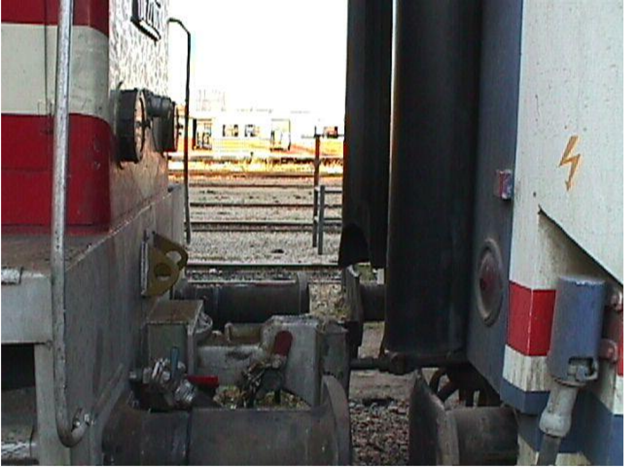
Koşum takımı bağlantı örneği (şofaj kablosu sağda görünmekte)
