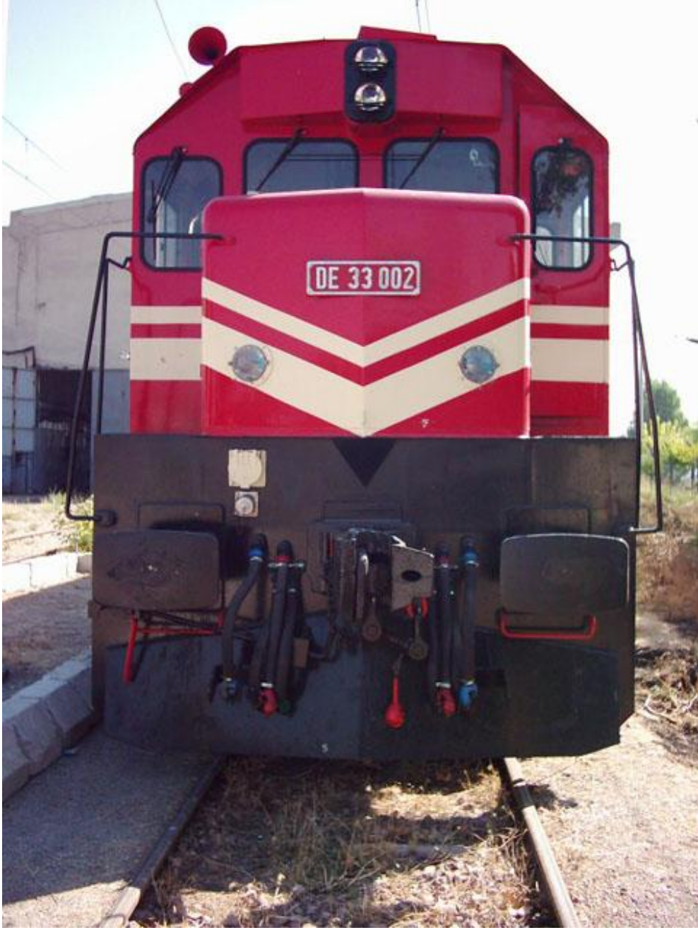
DE33002 lokomotifinde SA3 tipi kuplör ve hemen altında koşum takımı üzengisi
