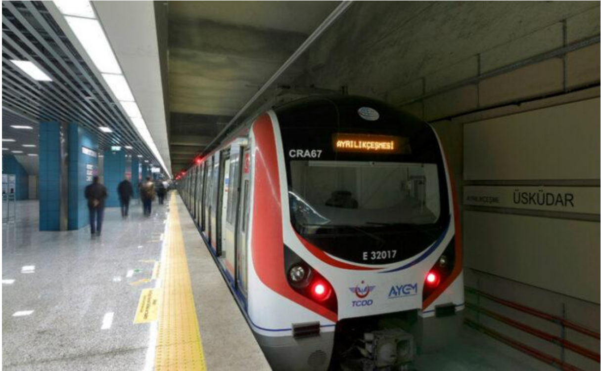
Üsküdar İstasyonu’nda bulunan bir Marmaray seti. Scharfenberg kuplörü de görünmektedir.
